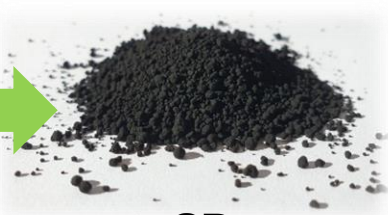
rCB 0,8 - 2 mm Hardness 35 – 50 cN
