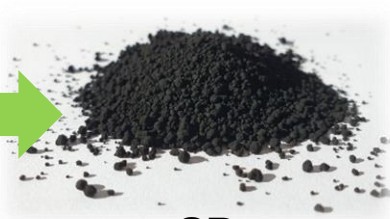
rCB 0,8 - 2 mm Hardness 35 – 50 cN
